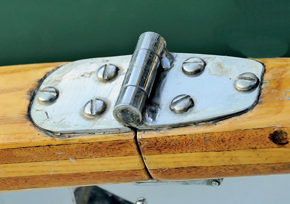
Rodergångjärnet är monterat med grov plåtskruv. Låsbeslaget framgår av ingressbilden.
