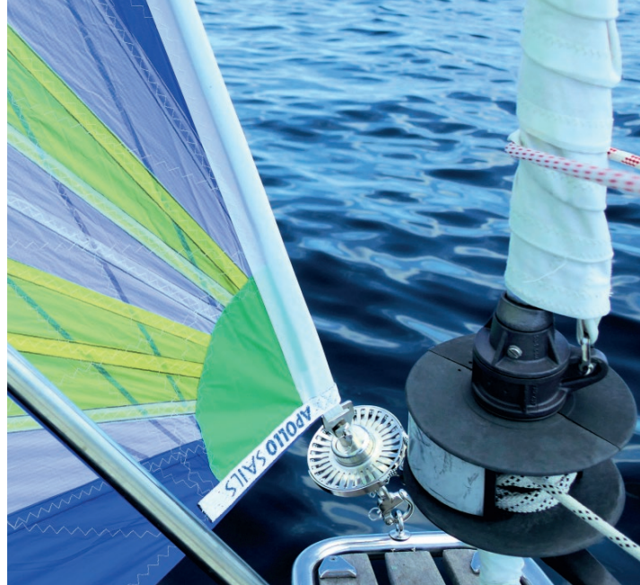
Rullen till gennakern är liten och smidigt jämfört med rullen till focken.
