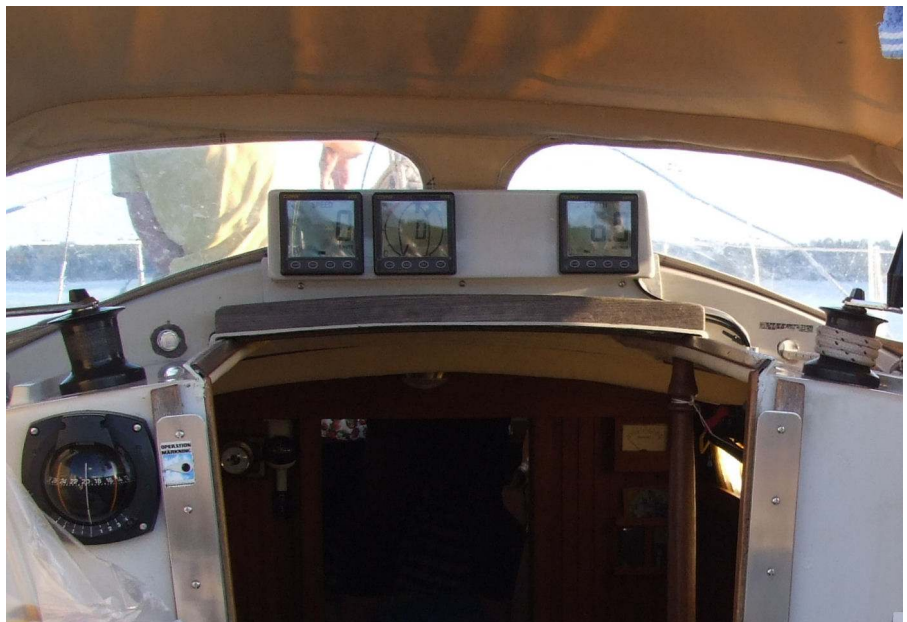
Instrumentkonsolen monterad i båten. Det tomma utrymmet på konsolen är lämnat för kommande slavdisplay till vindinstrumentet "kryssindikator"
