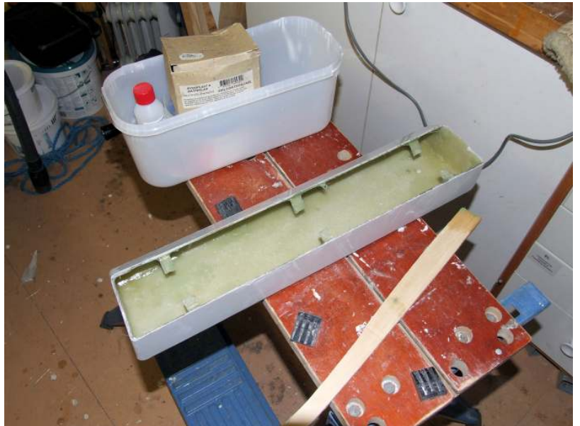
Konsolen gjuten och tagen ur formen. Små plastvinklar har plastats fast och ska utgöra stöd för baksidan, som skruvas i dessa
