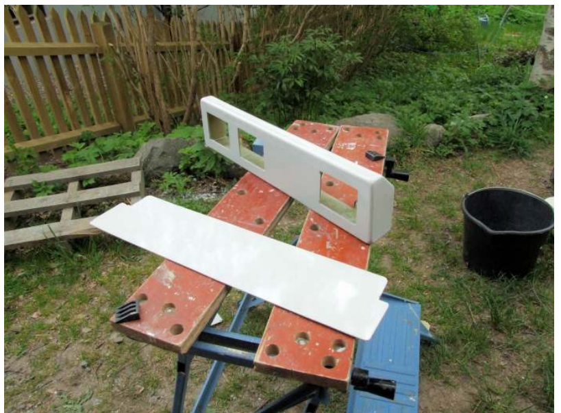
Bakstycket har profilerats och i konsolen har hål för instrumenten sågats
