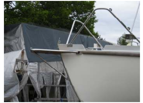
Monteringsanvisningen anger att stödbenet ska ha en vinkel mot peket på minst 25°. Vi valde en något större och stabilare vinkel
