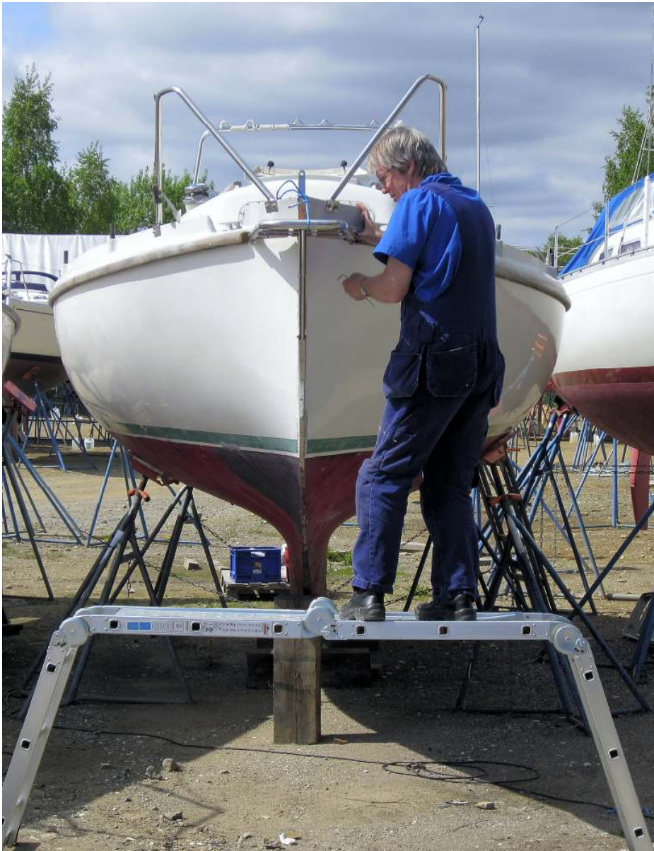
Monteringsanvisningen anger att stödbenet ska ha en vinkel mot peket på minst 25°. Vi valde en något större och stabilare vinkel
