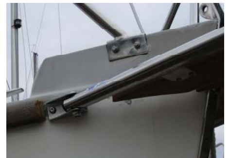
För att få peket så högt upp som möjligt tvingades vi kapa främre delen på avvisarlistan
