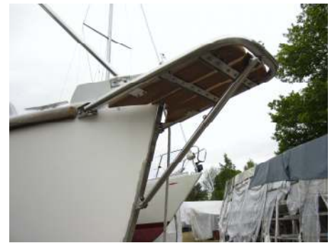
Stödbenets infästning placerades så en av befintliga skruvar i stävskenan kunde användas
