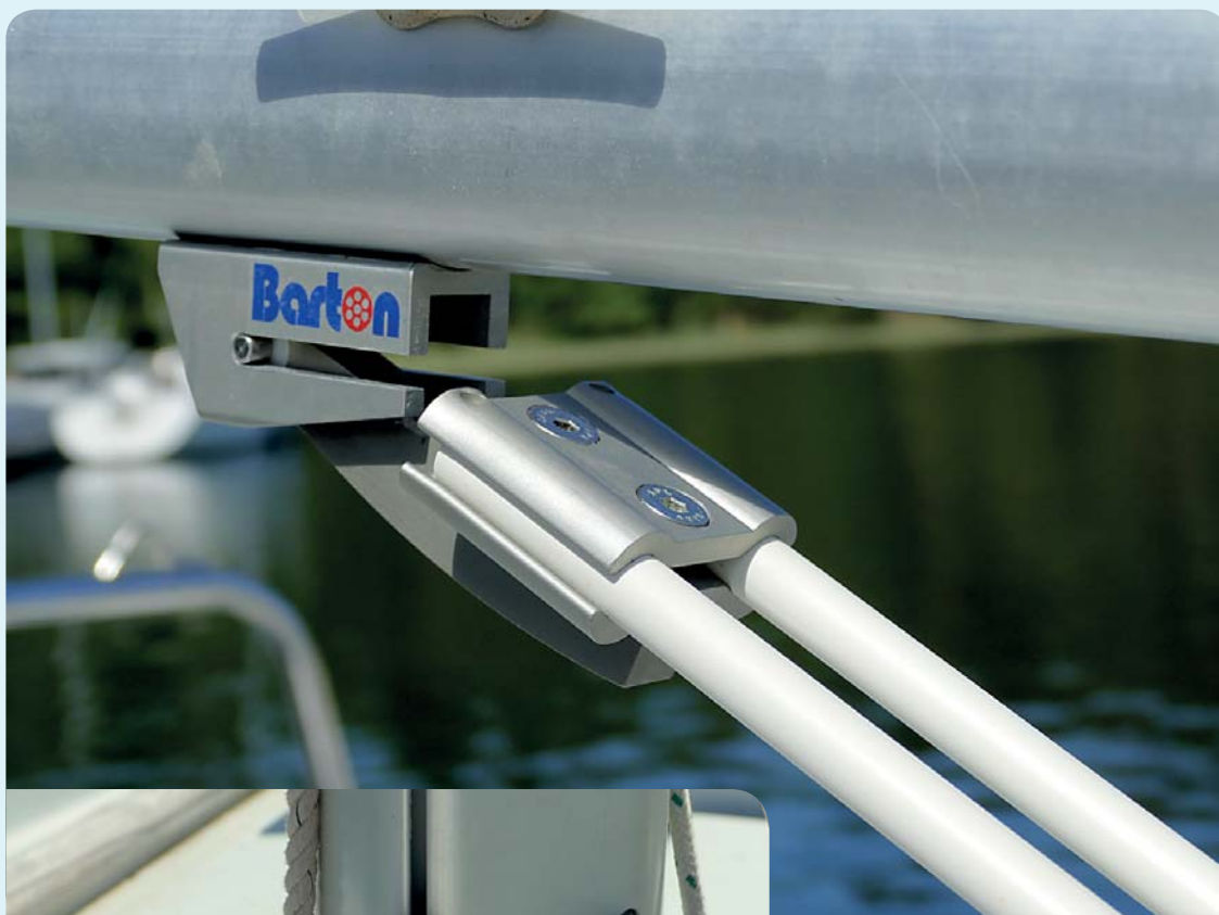
Infästningen i bommen sker med gängad maskinskruv. Borr och gängtapp är vad som gäller.
