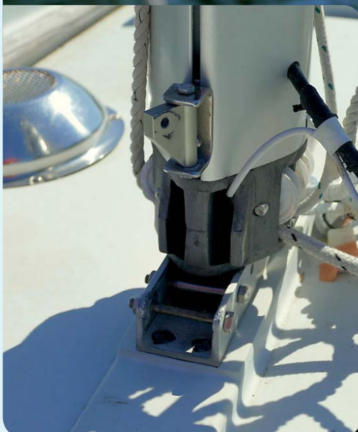
Det rörliga beslaget på masten monteras enkelt genom att mastfoten tas bort och beslaget träs in i likrännan.
